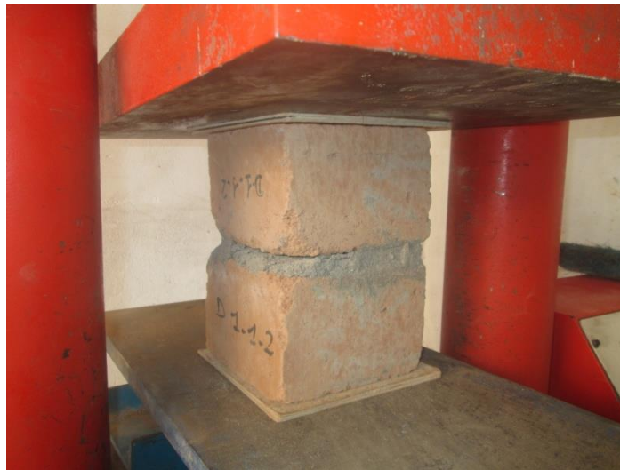
Figure 5. Photo de l'essai de compression simple
