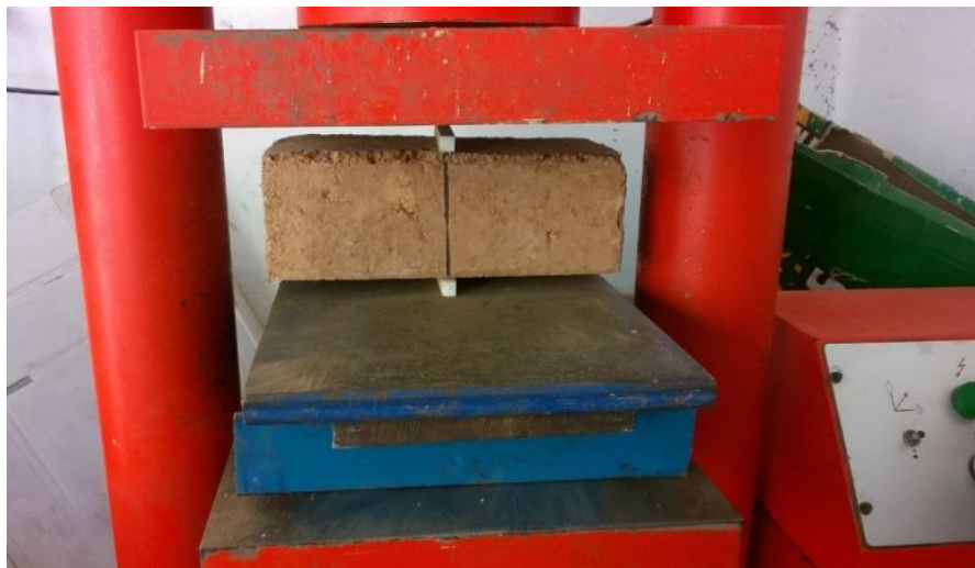
Figure 6. Photo de l'essai de traction par fendage
