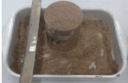
Figure 4. Mesure de la densité apparente du sable 0/5
