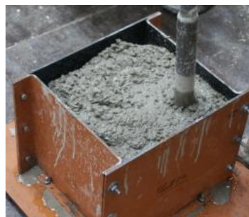
Figure 4. Mise en œuvre du béton dans le moule
