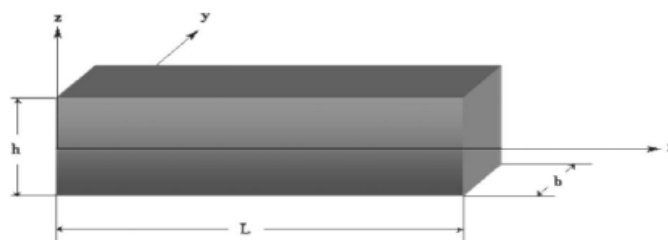
Figure. 1 Coordonné et géométrique de poutre fonctionnellement gradue.
