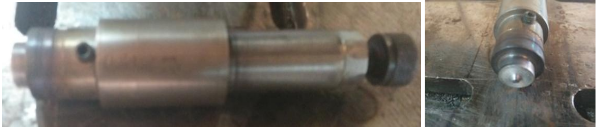
Figure 1. L'outil pour le soudage FSW.
