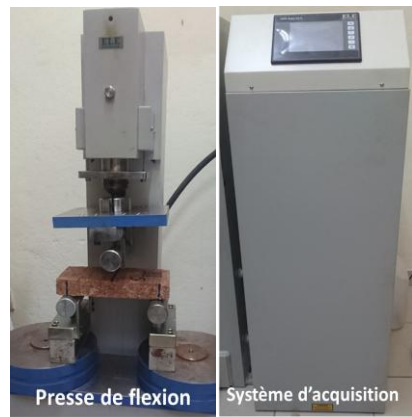
Figure 1 : Dispositif de flexion
