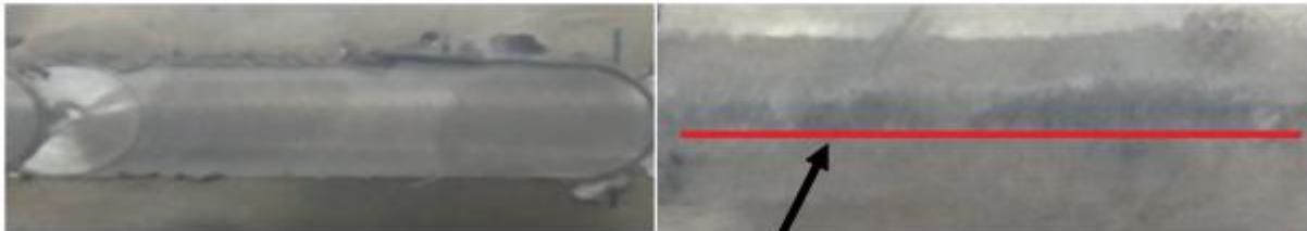
Figure 4. Joint avec bavures et fond de soudure.
