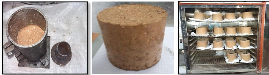
Figures 5 : Essai de compactage statique pour déterminer de la teneur en eau.
