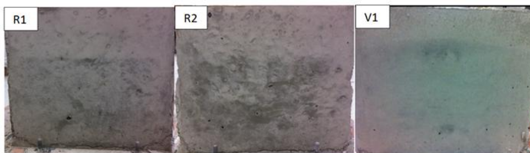
Figure 6. Parement en béton de R1, R2 et V1 à 1 jour
