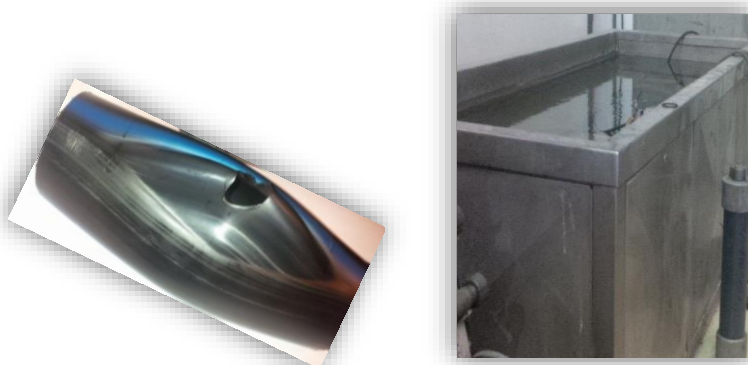
Figure 5. Le bain d'eclatement ,et l'exemple d'une éprouvette éclaté
